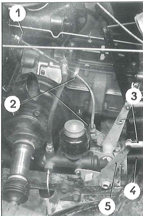
**REPLACEMENT D'UN CABLE DE DEBRAYAGE.****DEPOSE.****1. Décrocher le ressort (4) de rappel.**
