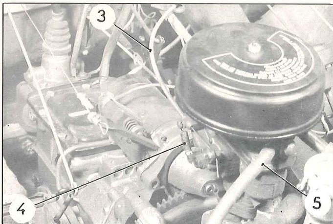
**3. Déposer le carburateur, dégager l'entretoise (7).****4. Obturer l'orifice de la tubulure d'admission à l'aide d'un chiffon afin d'éviter l'introduction d'un corps étranger.****POSE.****5. Enlever le chiffon placé à la dépose.**
