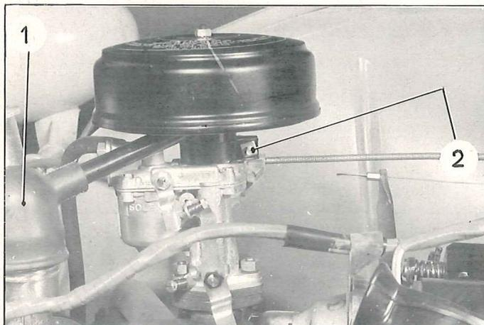
**DEPOSE.****1. Déposer le filtre à air :**
