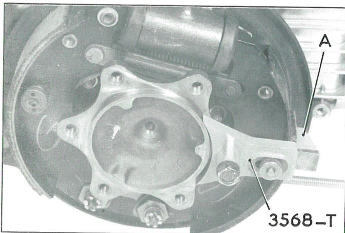
c) Régler l'index (A) de l'appareil, pour qu'il effleure la garniture à la partie supérieure du segment.
