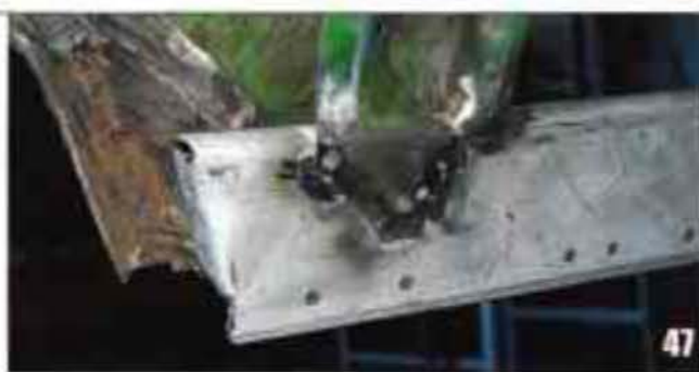
Vue de l'intérieur de la tôle d'auvent avec le brancard soudé au Mig.
