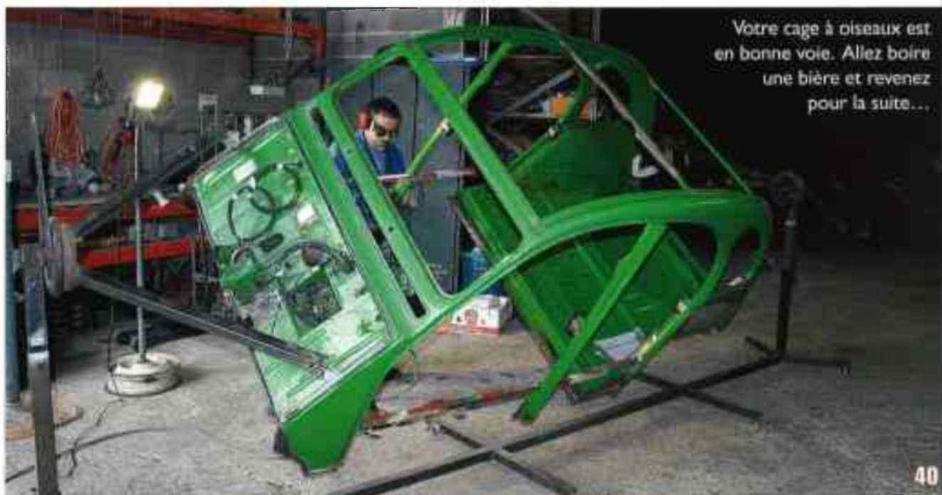
Vous le voyez, nous avions une caisse si pourrie de rouille qu'il a fallu changer aussi des parties du caisson de siège arrière. Nous vous montrerons cette opération dans un autre article. Passons à la pose des brancards. Présentez le brancard et maintenez-le en place avec des pince-étau. Mesurez pour retrouver l'endroit exact où était le vieux brancard et repositionnez le nouveau à la bonne place.
