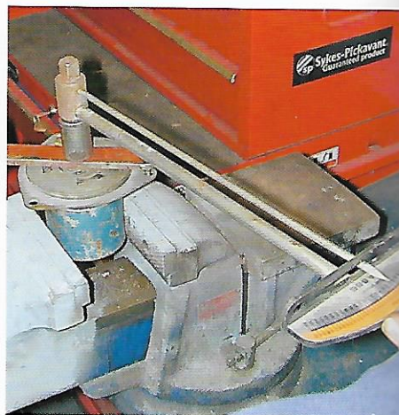
7-7-10. Replacé sur l'outil (universel !) avec l'écrou de pression vers le bas, l'amortisseur à friction est testé. Utilisez une clé dynamométrique adaptée sur l'outil spécial de positionnement 3451-T (genre de broche à ergot). L'amortisseur doit accepter le glissement à 16 N.m. S'il glisse plus tôt, resserrez l'écrou, et inversement.
