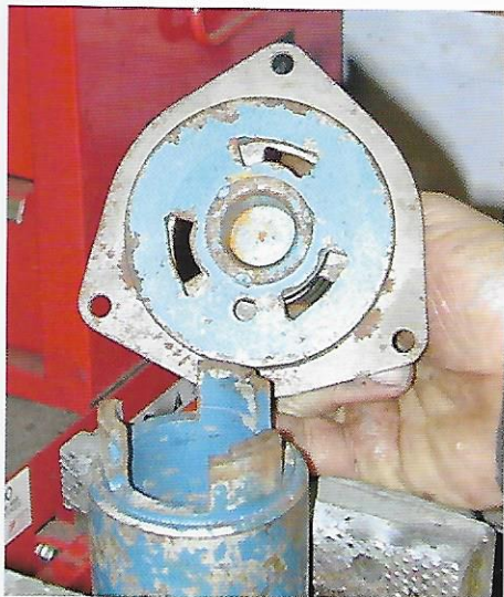
7-7-6. Avec l'aide de l'outil, démontez l'amortisseur à friction.
