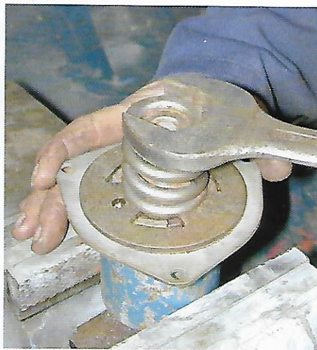
7-7-9. L'opérateur règle à présent la friction en tournant l'écrou (cela agit sur la force du ressort).
