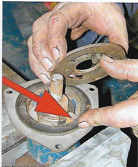
7-7-8. Lors du remontage, positionnez correctement la languette d'arrêt dans l'encoche du disque (flèche) avant de replacer le plateau de pression.
