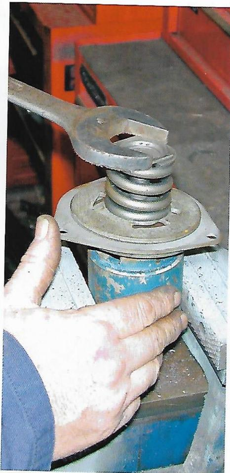
7-7-5. L'outil artisanal est un simple cylindre de métal dans lequel sont taillées trois dents, exacte réplique de la traverse Citroën (certains utilisent l'extrémité d'une traverse inutilisable). On peut ainsi monter les disques d'un côté ou de l'autre, s'il s'agit de les équiper ou de régler la tension du ressort de pression.
