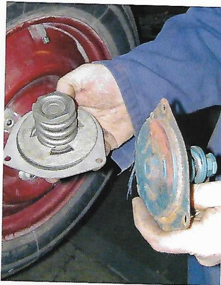
7-7-4. Le module amortisseur complet peut être retiré de la traverse à l'aide d'un outil spécial dont la fonction est de détendre le ressort.
