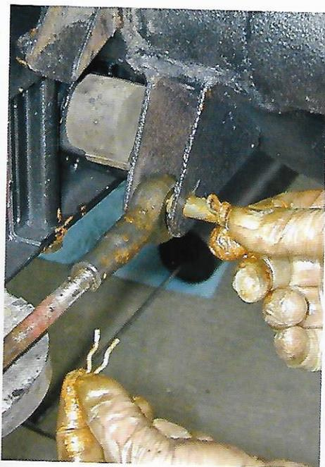
7-6-24. Après avoir enduit en abondance une graisse collante résistant à l'eau, approchez la chape du bras de suspension et introduisez l'axe déjà équipé d'une de ses agrafes. Veillez au bon encliquetage des agrafes (à l'aide d'un miroir pour celle de derrière). À l'usage et lors des entretiens courants, vous nettoierez cette zone avec un solvant dégraissant afin de la débarrasser de la crasse et des poussières, et vous graisserez de nouveau.
