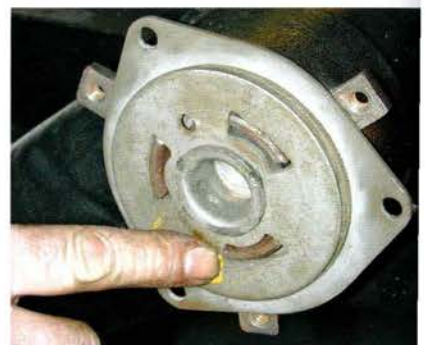
7-7-10. Replacé sur l'outil (universel !) avec l'écrou de pression vers le bas, l'amortisseur à friction est testé. Utilisez une clé dynamométrique adaptée sur l'outil spécial de positionnement 3451-T (genre de broche à ergot). L'amortisseur doit accepter le glissement à 16 N.m. S'il glisse plus tôt, resserrez l'écrou, et inversement.
