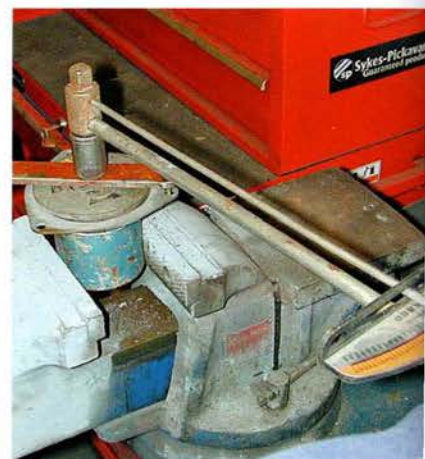
7-7-10. Replacé sur l'outil (universel !) avec l'écrou de pression vers le bas, l'amortisseur à friction est testé. Utilisez une clé dynamométrique adaptée sur l'outil spécial de positionnement 3451-T (genre de broche à ergot). L'amortisseur doit accepter le glissement à 16 N.m. S'il glisse plus tôt, resserrez l'écrou, et inversement.
