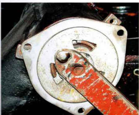
7-7-8. Lors du remontage, positionnez correctement la languette d'arrêt dans l'encoche du disque (flèche) avant de replacer le plateau de pression.
